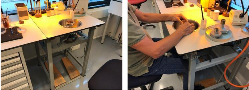
Bild 1. Fußgetriebene Poliermaschine in einer Optikfertigung in Delft, Niederlande.
